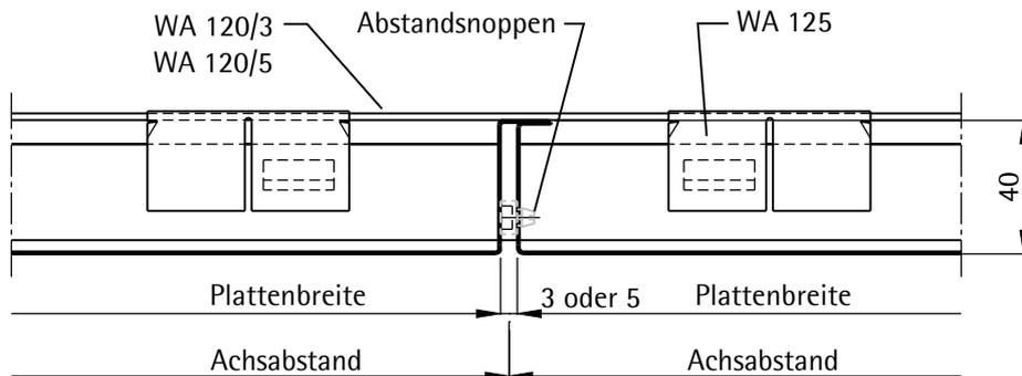
Regelschnitt im Bereich der Abhängung
