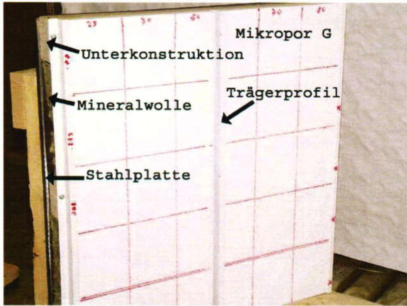
Aufbau der Versuchsplatte Mikropor G
